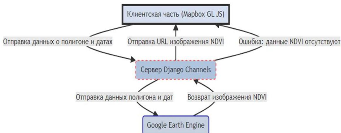
Рисунок 6 - Схема работы веб-ГИС приложения на примере получения анализа ndvi
